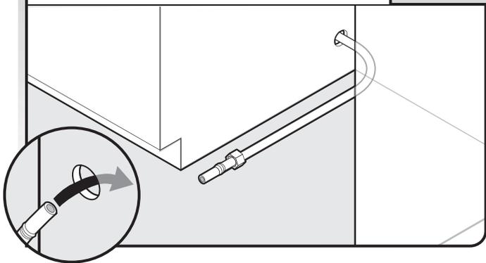
Faire passer prudemment le tube de raccordement à travers le trou percé dans le placard. (Le tube de cuivre peut s'écraser/se déformer facilement lors d'une flexion; procéder prudemment.) Il faut que la longueur de la section qui dépasse dans l'espace d'encastrement soit suffisante pour le raccordement à l'entrée du lave-vaisselle sur le côté gauche/à l'avant du lave-vaisselle.
